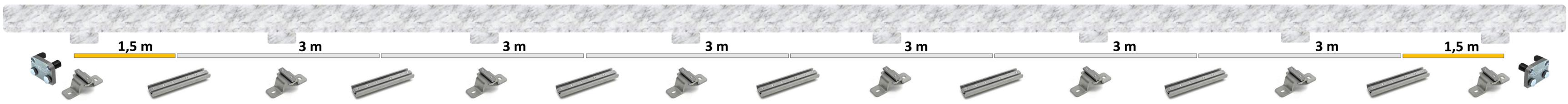
**Interasse < 3m (esempio di interasse = 2,5 m)**
