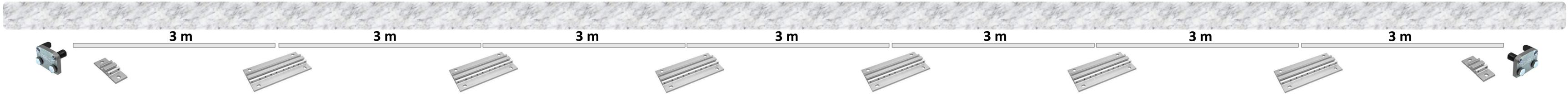
Installazione possibile con fissaggi ogni 3 m, ma con limitazione di spazio utile per il fissaggio delle staffe → usare staffe in acciaio e connettore strutturale
