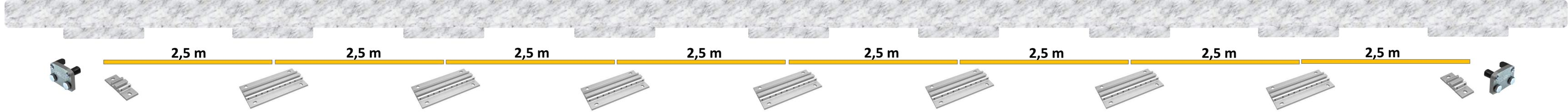
Installazione possibile con fissaggi ogni 2,5 m, ma con limitazione di spazio utile per il fissaggio delle staffe → usare staffe in acciaio e connettore strutturale
