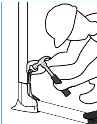
**4** - Con un martello inserire il cuneo di bloccaggio tra il montante e la base.
