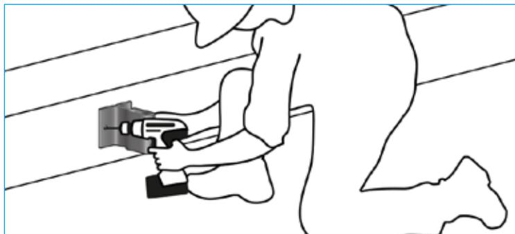
**1** - Tracciare un punto di riferimento ad ogni 1500 mm al massimo. \*La dimensione tra il montante e il bordo del cordolino deve essere di 500 mm per il parapetto dritto e di 750 mm per il parapetto inclinato.
