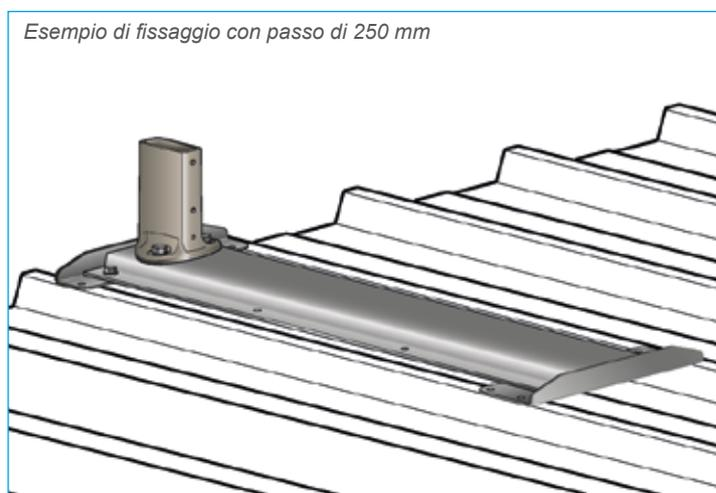
**2** - Posizionare le piastre di montaggio, passo 250 mm o passo 333 mm, per parapetto fissaggio su lamiere grecate perpendicolare alle onde
