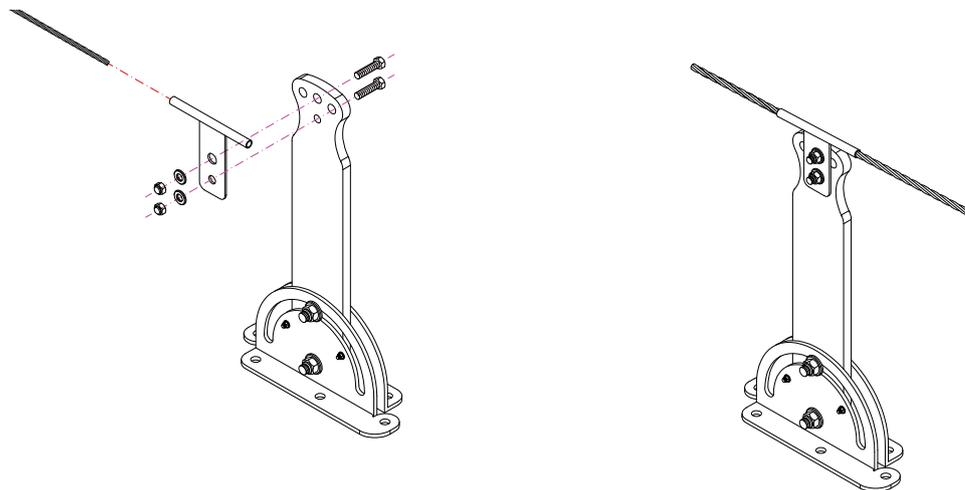
**Figura 4.23 - Assemblaggio del dispositivo SICURSLIM con passacavo dritto fisso per navetta (Cod. 001346)**
