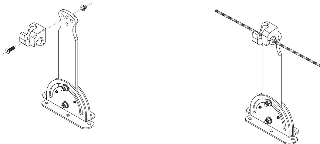
**Figura 4.22 - Assemblaggio del dispositivo SICURSLIM con passacavo in alluminio (Cod. 001094)**
