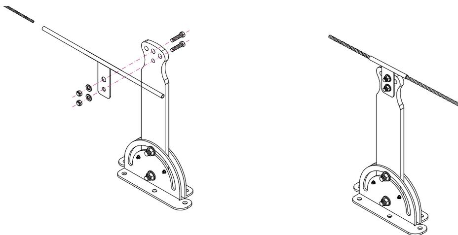
**Figura 4.24 - Assemblaggio del dispositivo SICURSLIM con passacavo dritto regolabile per navetta (Cod. 001347)**
