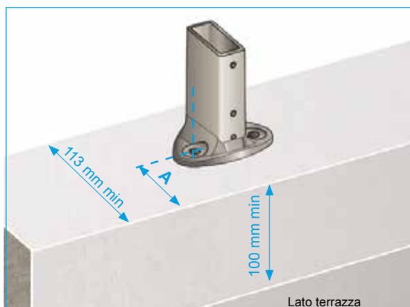
2 - Seguire le raccomandazioni per il fissaggio della base ad una distanza minima dal bordo del parapetto
