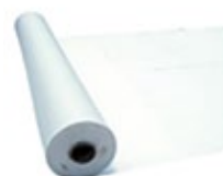
Cod. 001988 Weißes Geotextil, 2m Brei- te und 1,3 mm Stärke aus Polypropylen-Stapelfasern zwischen der Drainage - und Substratschicht. Bildet einen optimalen Filter beim Bau des mehr- schichtigen Dachgartens
