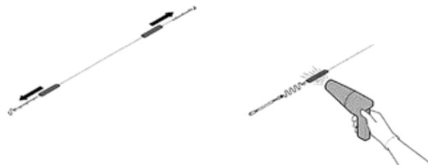
**Abbildung 5.5 - Erhitzung der Schrumpfhülle**
