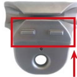
**Abbildung 4:34** - Im hinteren Teil des Fallschutz-Läufers befinden sich zwei Zacken, deren einzige Funktion das Greifen (nach der Ausübung eines leichten Drucks nach unten) und das Gleiten des beweglichen Teils ist.
