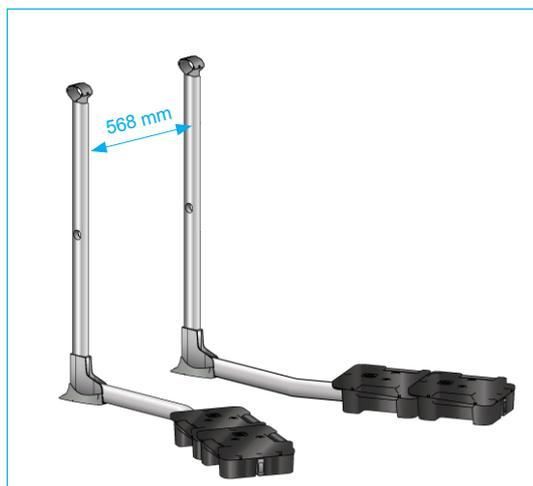
**3** - Posizionare i montanti e le gambe di sostegno con un interasse di 568 mm.
