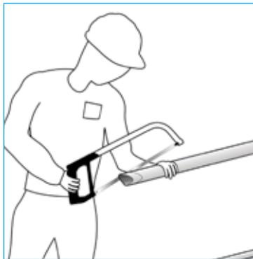
**9** - Regolare l'ultima sezione segando l'eccesso di tubo con riduzione
