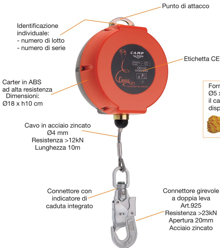
Fornito con cordino guida Ø5 x 10m, utile per guidare il cavo all'interno del dispositivo retrattile.
