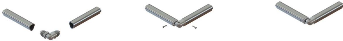
1. Unire le estremità e inserire l'elemento di giunzione
