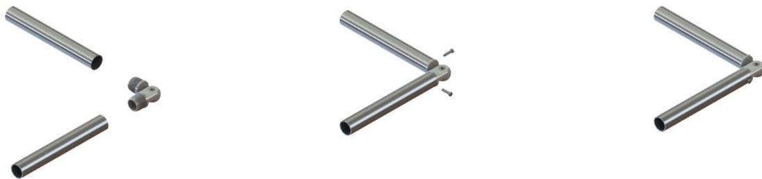
1. Unire le estremità e inserire l'elemento di giunzione
