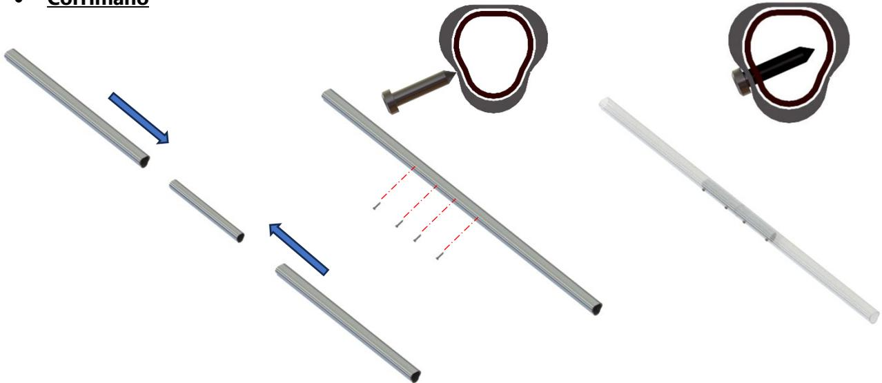
1. Unire le estremità e inserire l'elemento di giunzione
