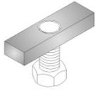
Fermo di fissaggio rettangolare con foro filettato M10 e vite TE in acciaio INOX. I dispositivi di fissaggio possono avere un interasse variabile da un minimo di 50 cm a un massimo di 3 metri. Per interassi di fissaggio oltre i 3 metri è necessario utilizzare un profilo di rinforzo. In relazione al numero di fissaggi varia il valore della freccia e dei carichi di sollecitazione.
