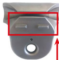
**Figura 4.41** - Nella parte posteriore della navetta sono presenti due dentelli con la sola funzione di permettere l'impugnatura e (dopo l'applicazione di una lieve forza verso il basso) lo scorrimento della parte mobile (Vedi Figura 4.42)
