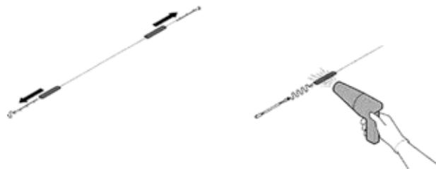
Abbildung 05.11 - Erhitzung der Schrumpfhülle
