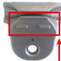
**Abbildung 4.43** - Im hinteren Teil des Fallschutz-Läufers befinden sich zwei Zacken, deren einzige Funktion das Greifen (nach der Ausübung eines leichten Drucks nach unten) und das Gleiten des beweglichen Teils ist (Siehe Abbildung 4.44)
