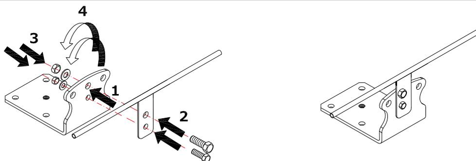
**Figura 4.31 - Assemblaggio del dispositivo LVB/LVBD con passacavo dritto regolabile per navetta (Cod. 001347)**
