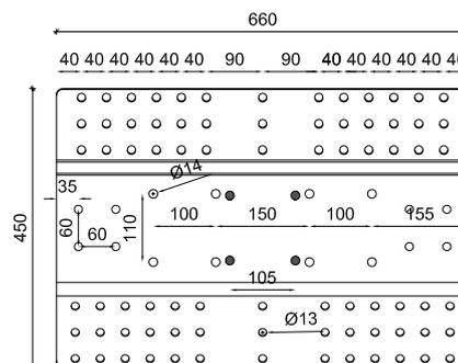
**Figura 3.4 - Dispositivo da colmo per ripartizione carichi (Cod. 000213) del dispositivo LVB/LVBD**
