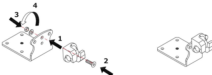
**Figura 4.29 - Assemblaggio del dispositivo LVB/LVBD con passacavo in alluminio (Cod. 001094)**
