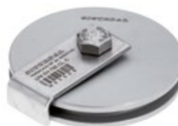
Cod. 000306 Winkelkabeldurchführung mit Elementen aus Edelstahl AISI 304 und Riemenschleibe aus Aluminium. Schrauben enthalten: Schraubenbolzen 16x50 + selbstsperrende Schraubenmutter und Unterlegscheibe Ø 16 mm aus Edelstahl
