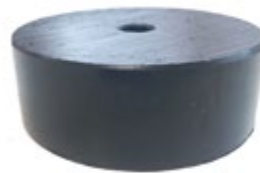
Cod. 002751 Träger aus Polyethylen mit Außendurchmesser 120 mm, Innendurchmesser 16,5 mm und Höhe 45 mm. Dient zu vermeiden, dass das Kabel die Bedachung berührt. Wird an die Zwischenvorrichtung SICURLAM/PLAM über Senkschrauben 14x80 mm befestigt
